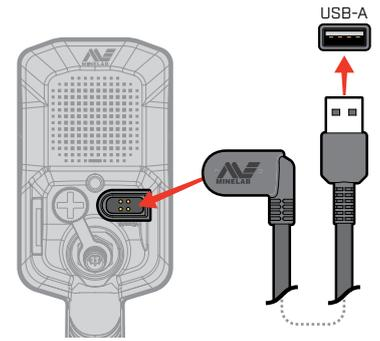
**ВНИМАНИЕ:** Заряжайте металлодетектор только с помощью качественного зарядного устройства с разъемом USB; его сила тока должна составлять не менее 2 А при напряжении 5 В. При использовании зарядного устройства низкого качества существует вероятность его выхода из строя.
